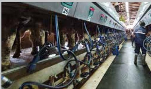
Für den Melkvorgang steht ein 2 x 24 Fischgrätenmelkstand zur Verfügung, allerdings nur für die hochlaktierenden Kühe. Frischlaktierende Kühe werden bis zu vier Tage nach der Kalbung in einem eigenen einfachen Sechser-Melkstand gemolken.
